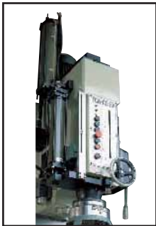
Ciclo neumático sincronizado emel (MTSE-MTCE-MVE). Emel pneumatic synchronised cycle (MTSE-MTCE-MVE). Cycle pneumatique synchronisé emel (MTSE-MTCE-MVE). Emel-synchronisierter Pneumatikzyklus (MTCE-MTCE-MVE).
