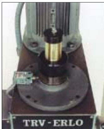
Conjunto husillo patrón con micro de seguridad. Lead screw set with safety micro. Groupe vis mere avec micro de sécurité. Gruppe Schraube mit Sicherheitmikro.
