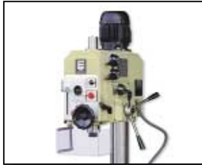
Volante frontal para avance sensitivo fino (TS) Frontal wheel for fine sensitive feed (TS) Volant frontal pour avance sensitif fine (TS) Vorderes handrad für den vorschub bei feinarbeitungen und plandrehen (TS)
